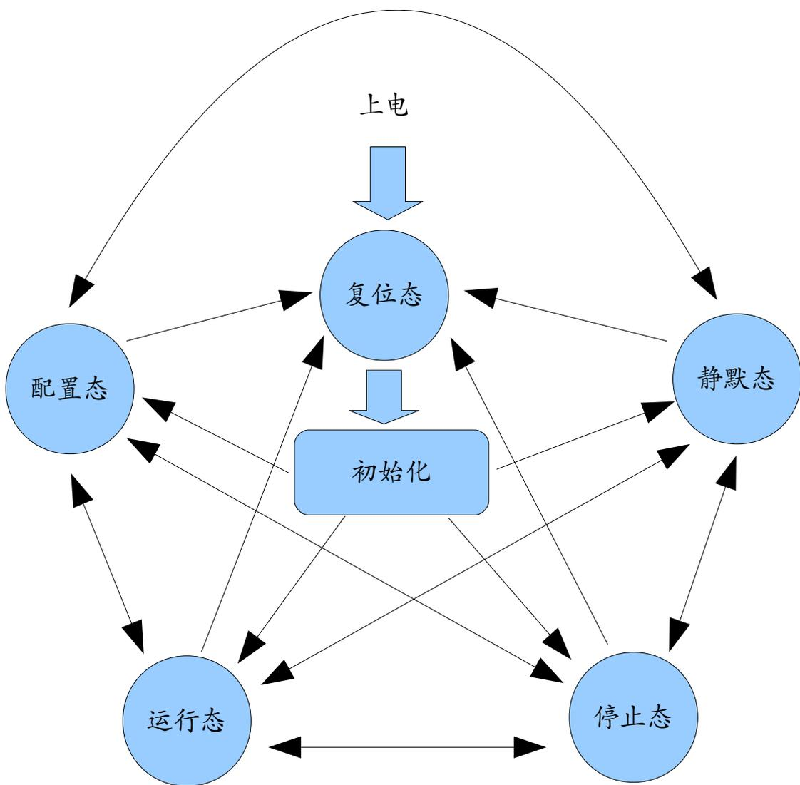
图 11—1 设备运行状态切换关系图
