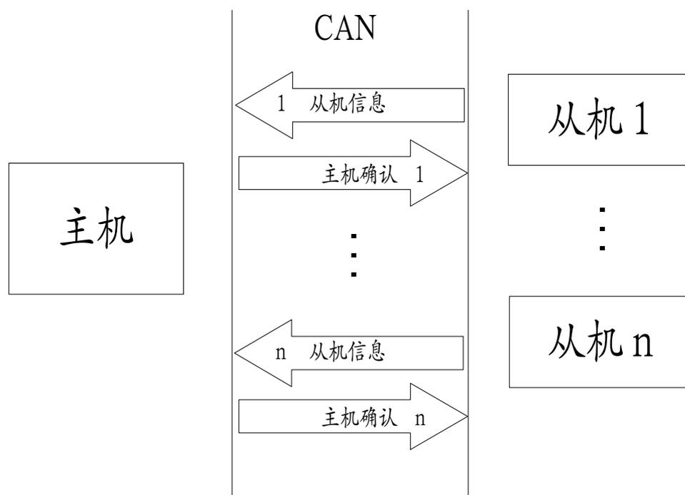
图 3—1 “信息/确认”方式框图
