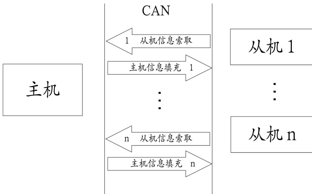
图 3—2 “索取/输送”方式框图
