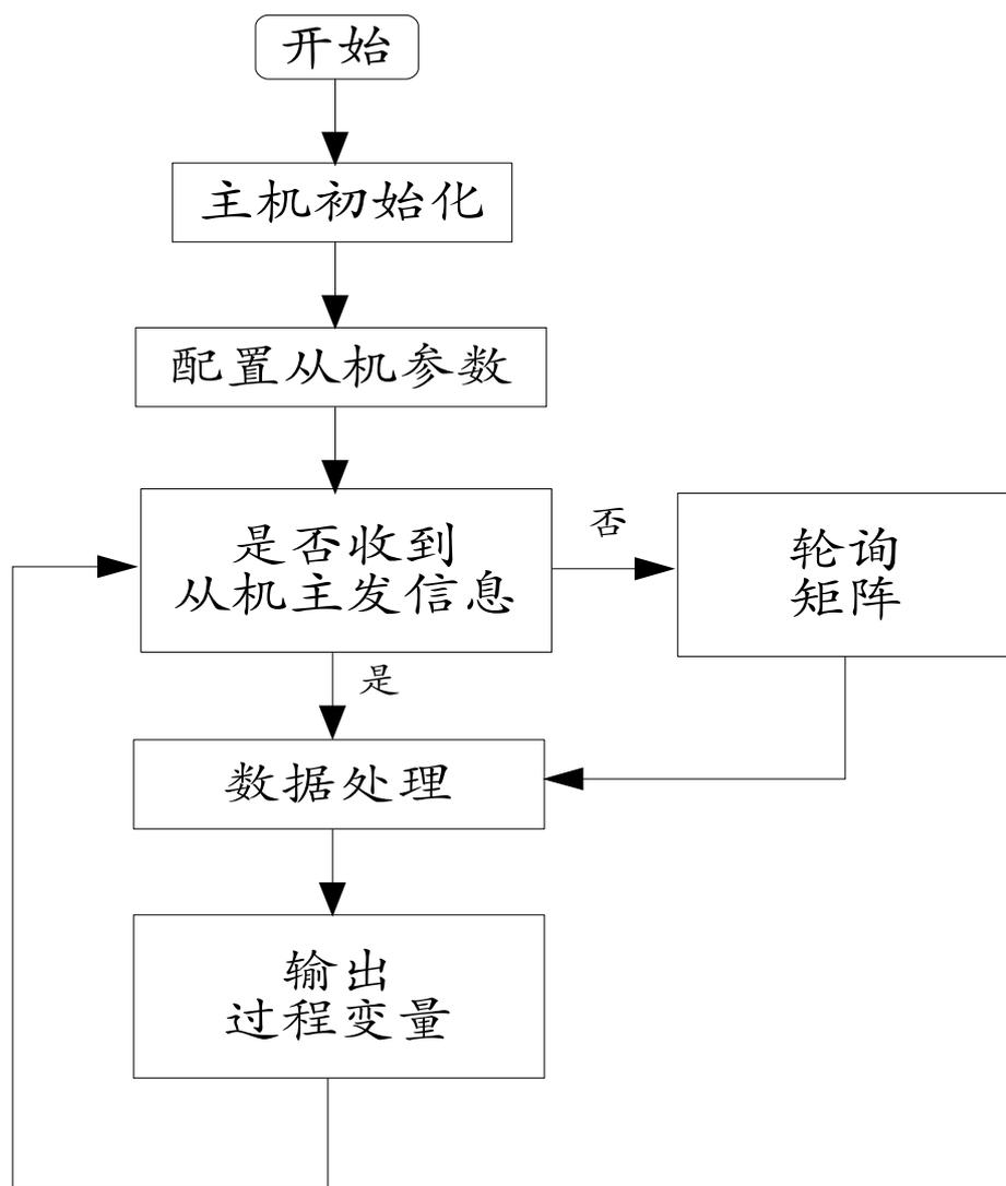
图 3—3 参考主机事务处理流程框图
